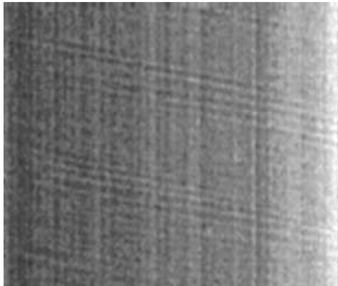
Fig. 19. Trenches de ondas, cerca del umbral.
