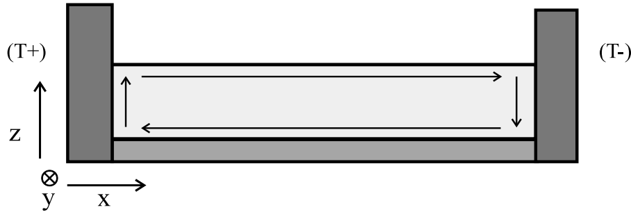
Figura 2.1: Esquema del flujo básico en un sistema de calentamiento lateral.
