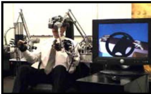
Figura 5.7: Sistema *Haptic Workstation* de Inmersión.
