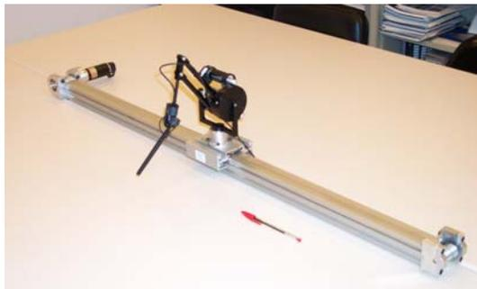
Figura 6.3: PHANToM sobre una guía lineal.
