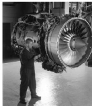
*Figura 1 Operación de mantenimiento en un motor de avión*
