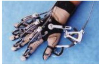
Figura 5.3: Exoesqueleto ligero *CyberGrasp* de Immersion.
