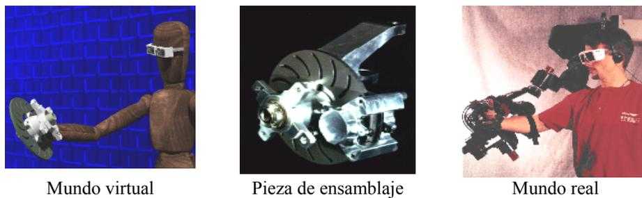
Figura 5.2: Brazo háptico de la empresa Sarcos para la evaluación de modelos CAD de ensamblajes mecánicos.
