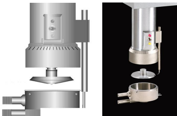
Figura 2.9. Esquema del viscosímetro Brookfield Digital Rheometer modelo HBDV-III+.
