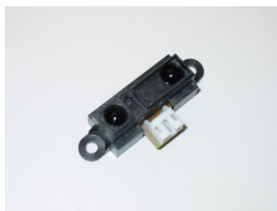
Figura 34. El sensor de infrarrojos GP2D12.
