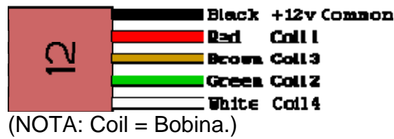
Figura 46. Pinamen de un motor PAP.
