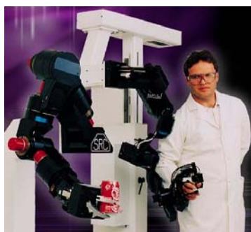
Figura 5.2 Sistema de teleoperación réplica comercializado por Sarcos 8
