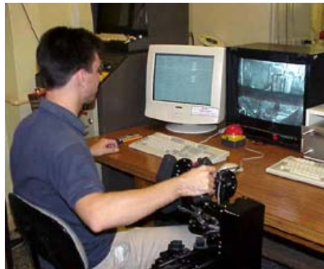
Figura 1.6 Proyecto RETINA: excavadora teleoperada.
