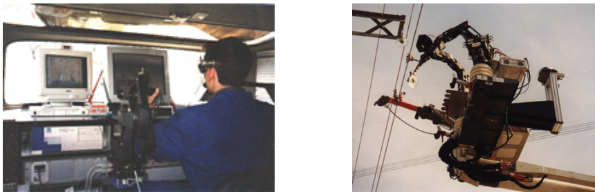
Figura 1.8 Prototipo Robtet para el mantenimiento de líneas de alta tensión.
