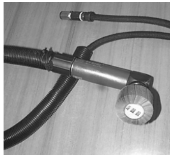
Figura 6.16 Herramienta neumática utilizada para las pruebas de desbastado.
