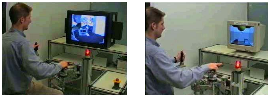
Figura 1.12 Interface háptico empleado tanto para la teleoperación como para la realidad virtual de la Universidad de Munich.
