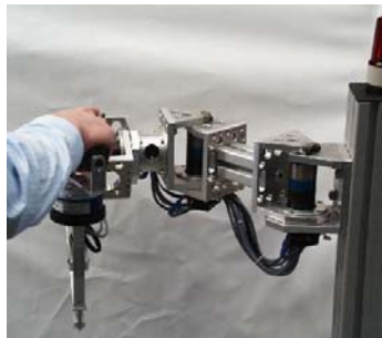
Figura 5.1 Robots maestro y esclavo de un sistema de teleoperación desarrollado en Instituto de Ingeniería de Control Automático (Universidad Técnica de Munich) 7 .
