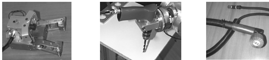
Figura 4.15 De izquierda a derecha, herramientas del robot esclavo: pinza, taladro y amoladora.
