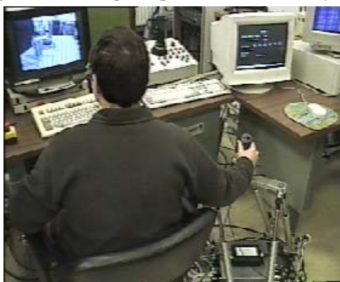
Figura 2.3 Operario manejando el robot maestro del dispositivo de teleoperación.
