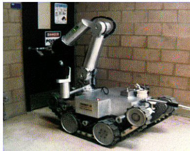
Figura 1.7 Telerobot para la manipulación y desactivación de explosivos.
