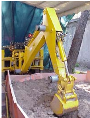
Figura 1.6 Proyecto RETINA: excavadora teleoperada.
