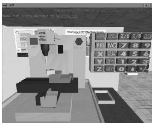
Figura 1.9: Sistema de entrenamiento de operarios de máquina herramienta
