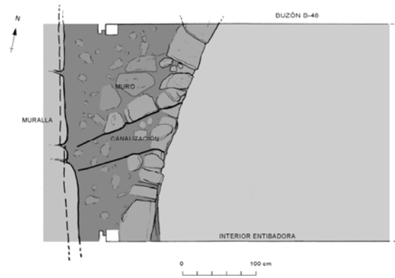
Detalle del muro del aljibe y localización
