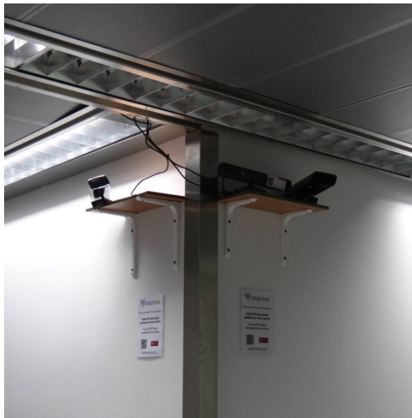
Figura 7. Imagen de tres cámaras Kinect instaladas en una esquina para la detección de ocupantes de dos pasillos.
