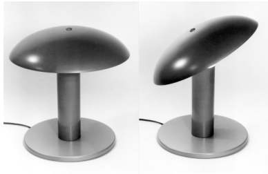
Lámpara de sobremesa de las habitaciones del hotel Dimensiones: Diámetro 200 mm, altura 250 mm Chapa y tubo metálico Sobre la bombilla, utilizada a modo de rótula, gira una pantalla con geometría de casquete esférico Fabricante desconocido
