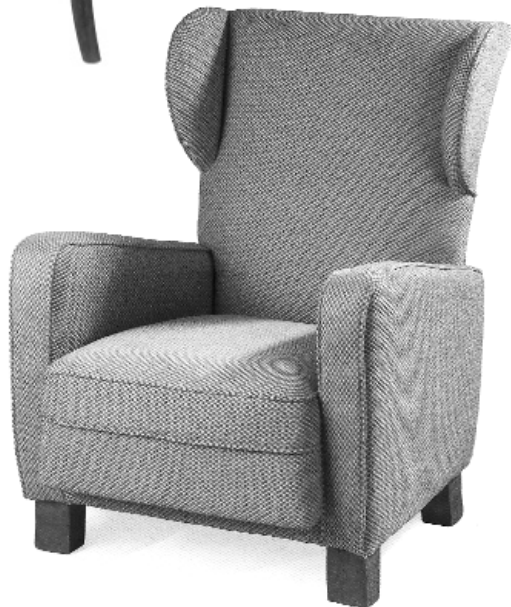
Butaca para los apartamentos del hotel Dimensiones: Frente 710 mm, fondo 820 mm, altura 980 mm Patatas de roble, armazón de pino y tapicería sobre relleno de crin muelles Fabricante: Santamaría y Cía
