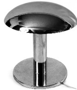
Lámpara de sobremesa de las habitaciones del hotel Dimensiones: Diámetro 200 mm, altura 250 mm Chapa y tubo metálico Sobre la bombilla, utilizada a modo de rótula, gira una pantalla con geometría de casquete esférico Fabricante desconocido
