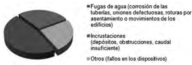
Fig. 15. Distribución habitual de las averías en fontanería y saneamiento 9
