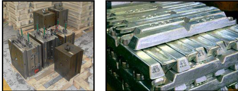
Figura 7. Moldes de acero y lingotes de “Zamak”
