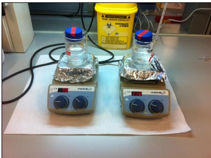
**Figura 5: Proceso de disolución de dos concentraciones de los polímeros A y B al baño María con agitación magnética.**
