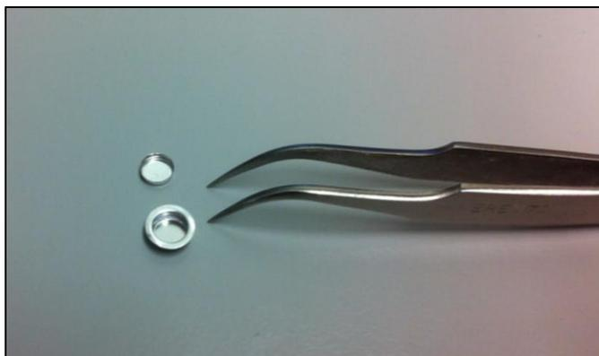
**Figura 10: Platillo de aluminio con la tapa en el cual se introducen las muestras para realizar los ensayos de calorimetría diferencial de barrido.**
