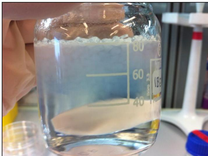
**Figura 6:** Proceso de disolución en el cual se puede apreciar dos fases, en la parte inferior del frasco una fase del polímero completamente disuelta, mientras que en la parte superior, aún se encuentra el polímero en forma de grana.
