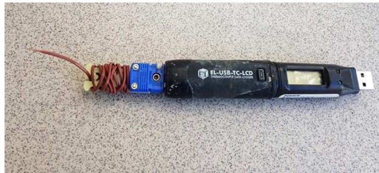
Figura 3.1 Termopar Tipo T conectado al Datalogger modelo USB-TC-LCD .
