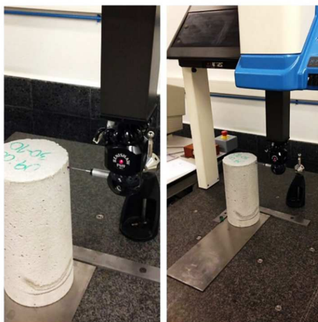
Figura 3.22 Medición de dimensiones con la máquina MMD de la empresa DEA MIS-TRAL de una probeta cilíndrica de diámetro nominal.
