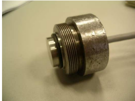
Figura 3.24 Sensor de presión colocado en la tapa inferior diseñada por Santilli (2010).
