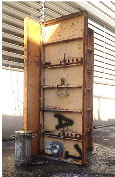
Figura 3.14 Encofrado LGR de 1'5 metros de altura.
