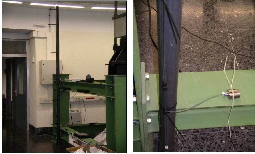
Figura 3.31 Tubería para verificar la calibración y unión de la misma al sensor de presión.
