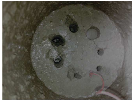
Figura 3.12 Termopar Tipo T colocado al mortero con las perforaciones correspondientes al ensayo de penetración.
