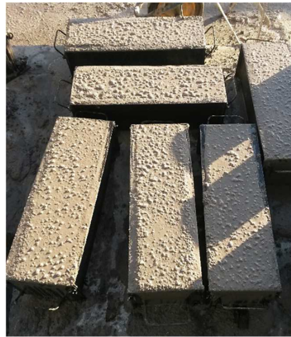
Figura 3.8 Viguetas de hormigón realizadas para llevar a cabo el ensayo del esclerómetro.
