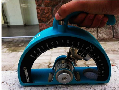
Figura 3.9 Ensayo con el martillo Schmidt OS-120 en una vigueta de HAC.
