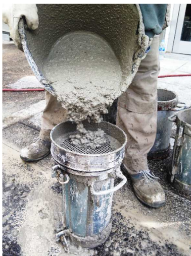
Figura 3.11 Tamizado de la muestra de hormigón a través del tamiz 4'75 mm.
