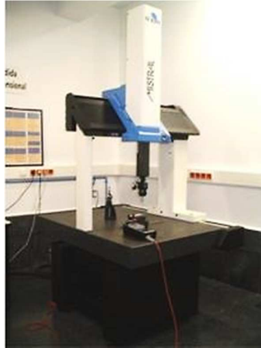
Figura 3.21 Máquina tridimensional (MMD) de DEA Mistral.
