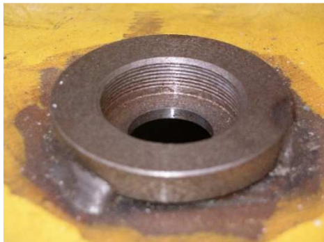
Figura 3.25 Tapa superior soldada al encofrado.
