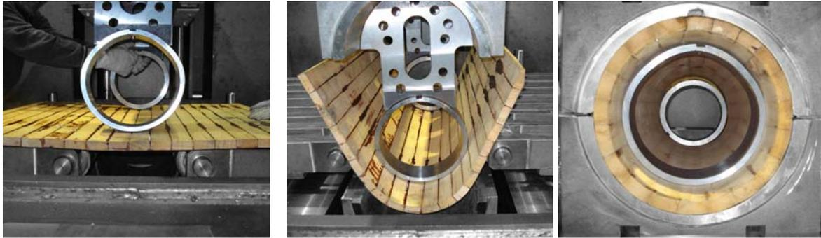
Figura 1. Proceso de fabricación de los tubos de madera conformada.
