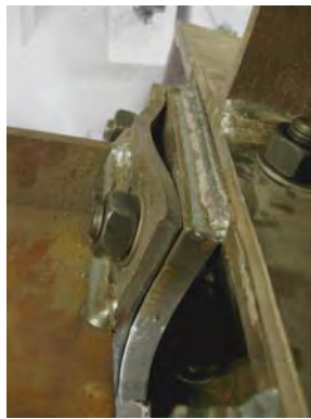
(b) Deformación de la chapa de testa de tracción y la chapa adicional
