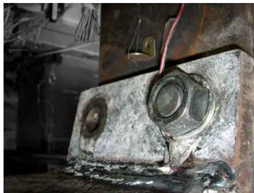
(d) Tornillo zafado de su rosca y tornillo roto en la zona de tracción
