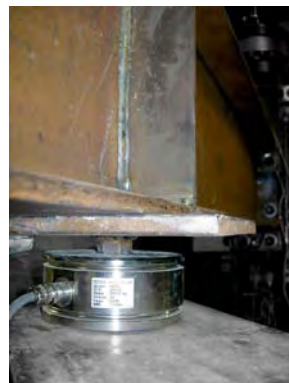
Figura 10.9: Materialización del apoyo de la viga como rótula. Medida de la reacción en el apoyo mediante una célula de carga
