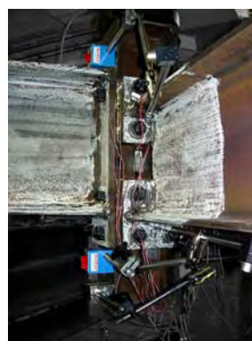
(c) Serie A. Colocación de los transductores lineales en la unión del eje menor
