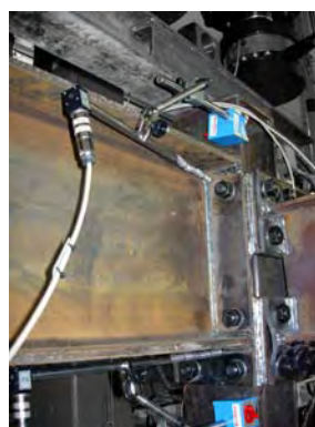
(d) Serie B. Monitorización de la deformación de la chapa de testa del eje mayor
