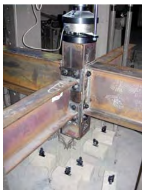
(c) Serie B. Unión ensayada y colocación de los sensores de hilo
