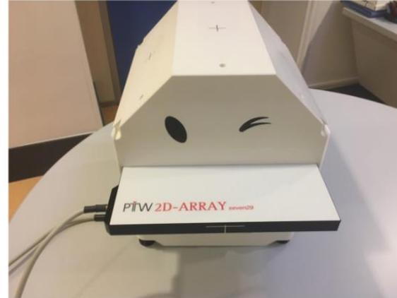
*Figura 5.1: Derecha: matriz de detectores PTW 2D array 729. Izquierda: maniquí PTW Octavius II con la matriz 2d array 729 insertada*
