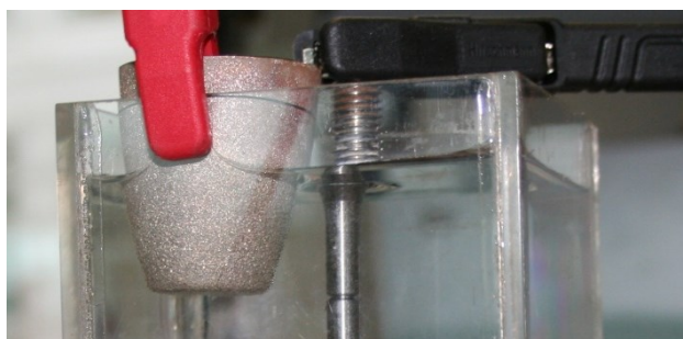
Figura 34. Probeta con la superficie impoluta tras una prueba de carga de hidrógeno con un crisol de platino como electrodo.
