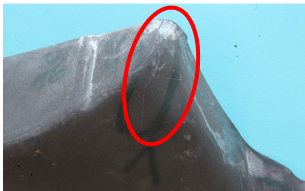
Figura 4. Grieta de rotura retardada en un componente de acero martensítico de alta resistencia estampado en caliente.
