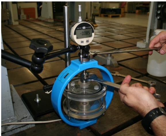
Figura 35. Tensionado de una de las probetas utilizadas en el estudio en un anillo de tensión.
