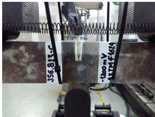
Figura 84. Montaje de ensayo utilizado para la caracterización de K_{Ith-EAC} .
