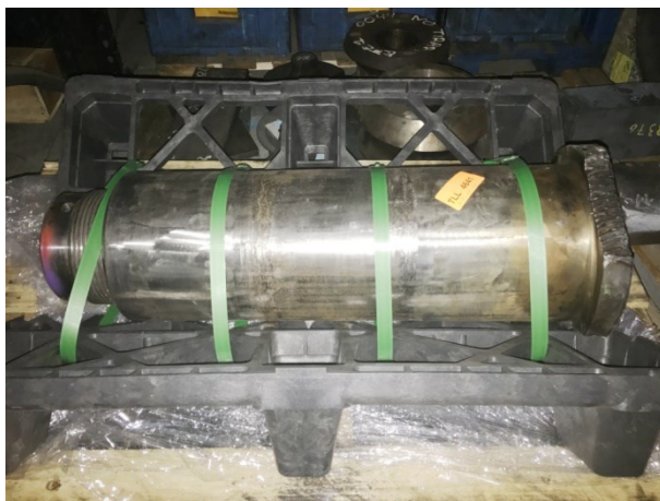
Figura 25. Accesorio “B” de cadena de acero R4 de \text{Ø}200 mm utilizado para los ensayos.
