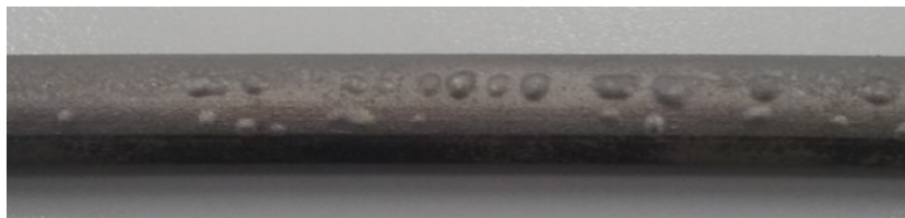
Figura 10. Vista macroscópica de la superficie ampollada de una probeta de aluminio [cortesía de ALFA IDEI].
