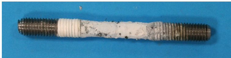
Figura 33. Probeta completamente recubierta de residuos de un electrodo de aluminio combinado con sales tras una de las pruebas de puesta a punto de los ensayos.
