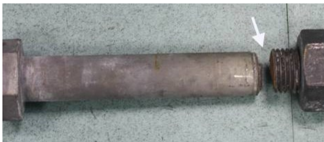
Figura 7. Tornillo M56 de grado 10.9 roto a una tensión inferior a su resistencia mecánica a causa de la intervención de la fragilización por hidrógeno.
