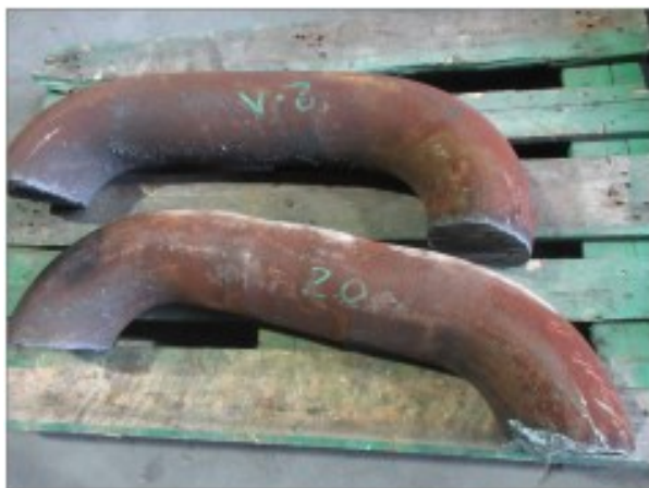
Figura 26. Eslabón “C” de acero R5 de \text{Ø}160 mm utilizado para los ensayos.
