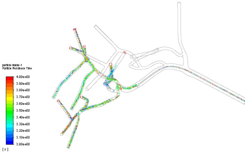
Figura 63: Ubicación de las microesferas 1 s antes de parar la simulación.
