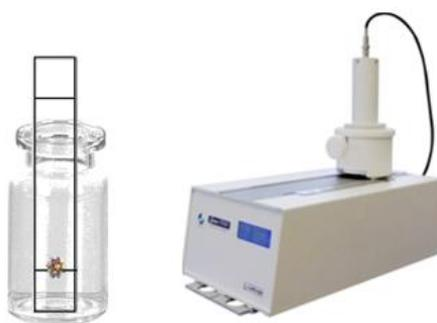
**Figura 24.** Cromatógrafo Scan-RAM (Lablogic ®) empleado para la determinación de la PRQ de las NPs marcadas (171)
