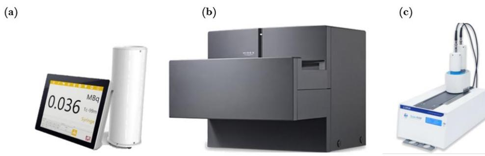
**Figura I. 11.** Detectores empleados en radiocromatografía para determinar el % PRQ. (a) activímetro: basado en una cámara que contiene un gas que se ioniza por la radiación emitida por el radionucleido; (b) contador gamma; (c) radiocromatógrafo. Ambos emplean cristales de centello como sistema de detección; los átomos que conforman el cristal centellean en presencia de radiaciones ionizantes.
