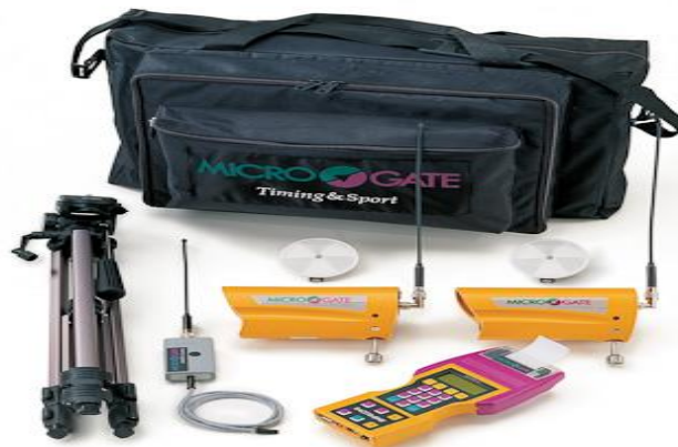
Figura 14: Células fotoeléctricas par el cronometraje de la velocidad de desplazamiento.
