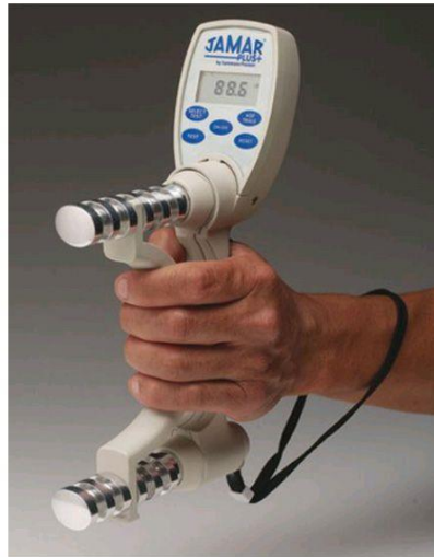
Figura 13: Dinamómetro manual para la medición de la fuerza de prensión.
