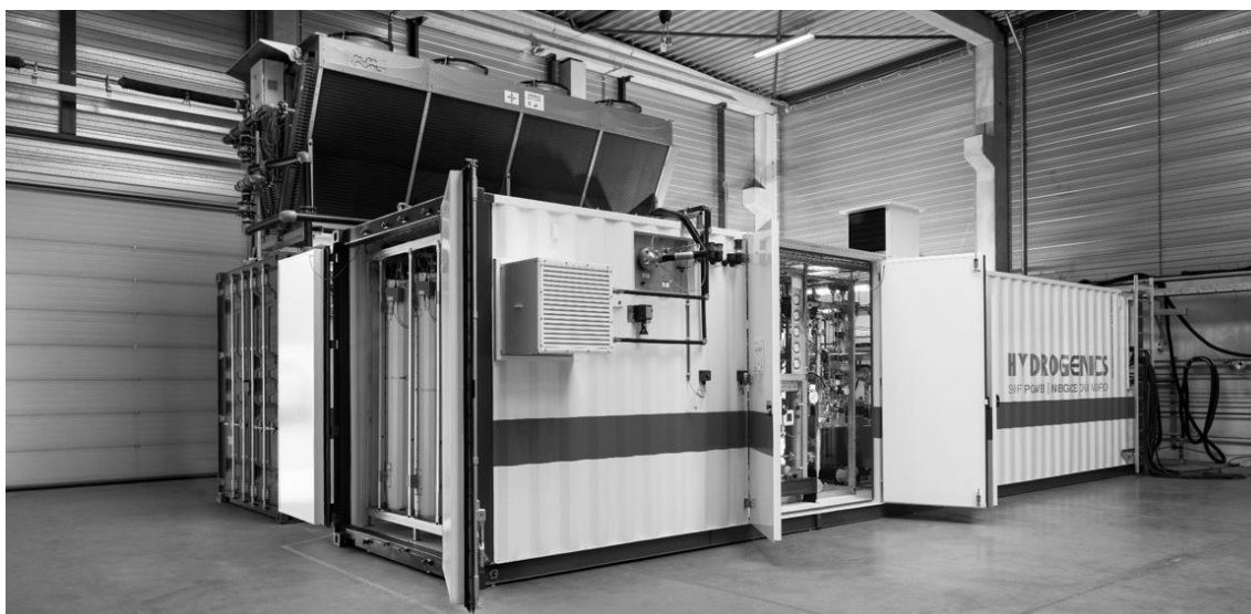
Figura 20 Electrolizador Hylyzer 500 de la marca Hydrogenics
