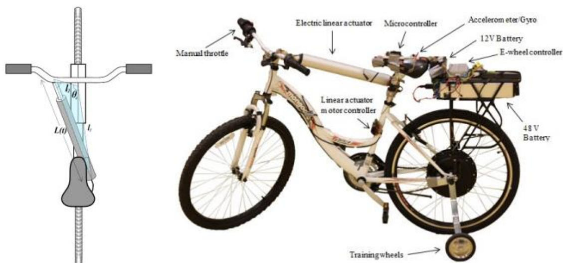
Figura 13. Croquis y modelo real de bicicleta autoestable mediante actuador lineal. Diseñada por la Universidad de Michigan-Dearborn [8].
