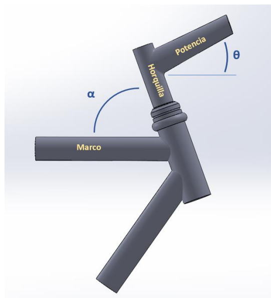
Figura 49. Esquema del sistema superior para el análisis de los efectos de la gravedad.
