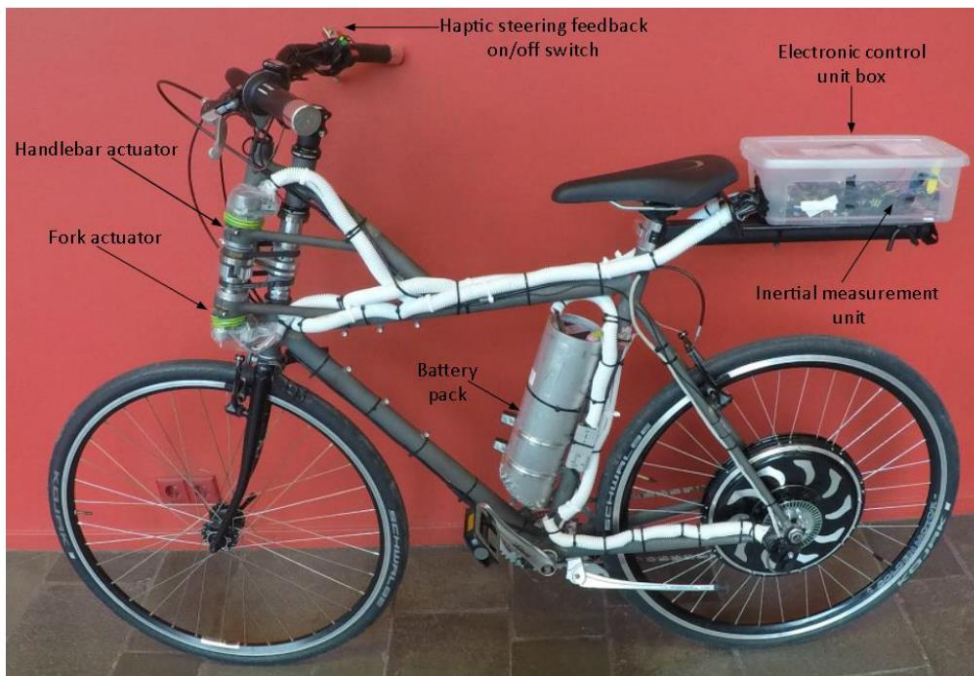
Figura 8. Modelo 2018 steer-by-wire llevado a cabo por la universidad de Delft [5].
