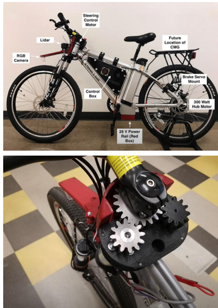
Figura 14. Modelo de dirección asistida para bicicleta llevado a cabo por la Arizona State University [9].
