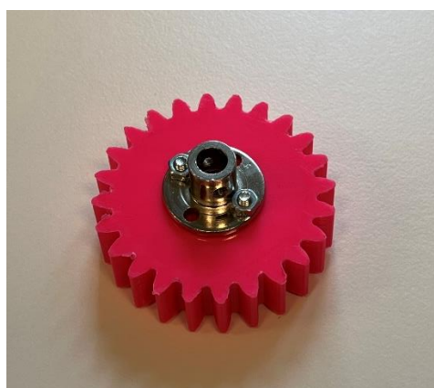
Figura 36. Piezas engranaje motor y acoplamiento de eje ensambladas.
