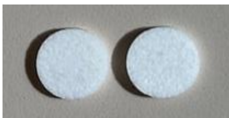
Fig. 4. Discos de fibras de 6 % (p/p) polivinilpirrolidona y 0,46% cloranfenicol producidas mediante SBS y comprimidas durante 1 minuto.
