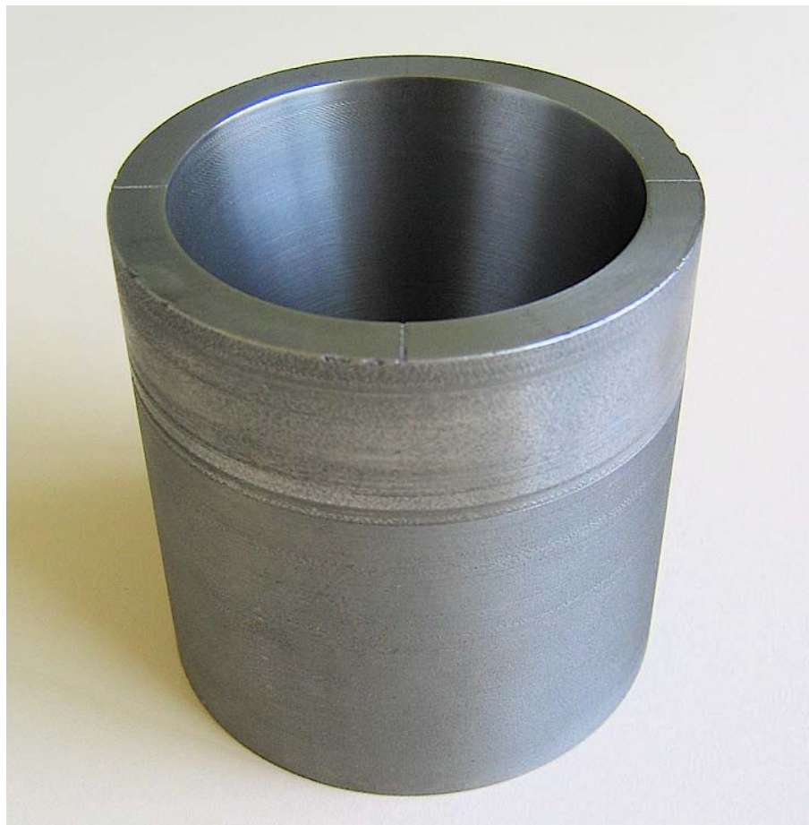
Figura 5.18: Molde de wolframio empleado para generar una distribución de fluencias gaussiana.
