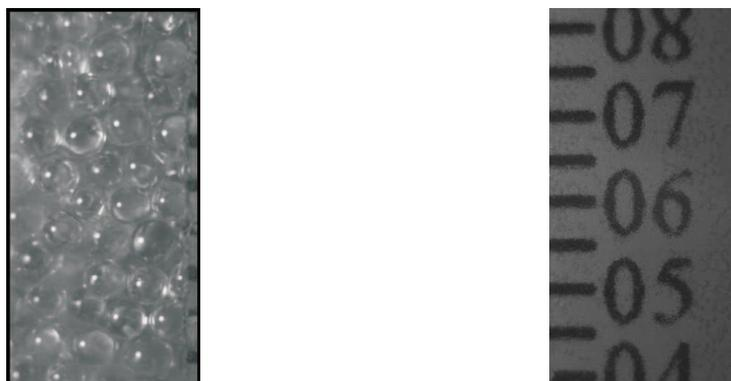
**Figura 2.5:** Izquierda, imagen de los granos en la pared. En el borde derecho de esta imagen aparece una escala graduada que se emplea para calcular la fase correspondiente a cada imagen. Derecha, imagen de la escala exterior para la conversión pixel–distancia.
